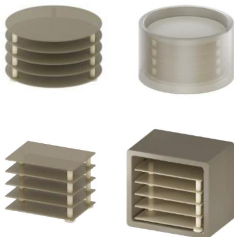
Lors de la cuisson d'émaillage, la répartition uniforme de la température dans le four est d'une importance décisive pour l'apparence ultérieure des pièces, car les émaux réagissent très sensiblement aux différences de température. Par conséquent, répartissez les pièces aussi uniformément que possible dans le four.
